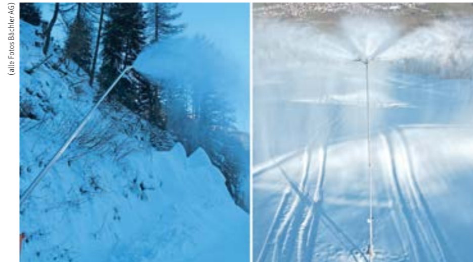
Effizienzsteigerung in den letzten 20 Jahren: Eine Bächler VANESSA mit einem Energy-Snow-Ratio von 0,71 kWh/m 3 (links) und die aktuelle SnoTek TRIDUSA mit einem ESR-Wert von 0,11 kWh/m 3 .
