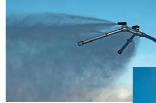
Der V-Strahl-Düsenblock der SnoTek MEDUSA Doppelkopflanze ermöglicht unter Optimalbedingungen einen Wasserdurchfluss von bis zu 15 l/s.
