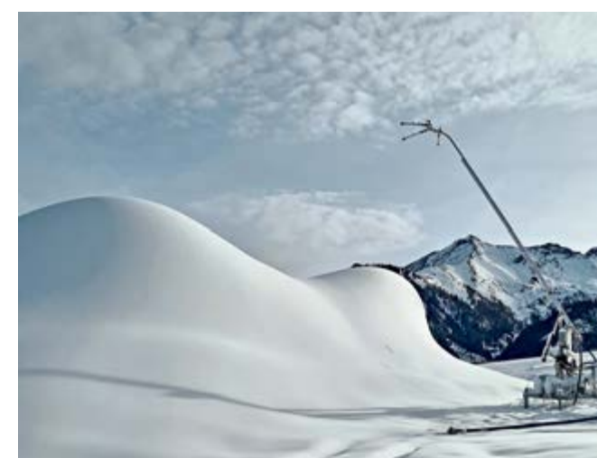
Bis zu 21 m 3 Schnee pro Stunde liefert die Lanze ab einer Grenztemperatur von -1,5°C FKT.
