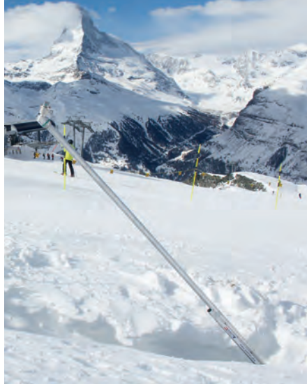
Schritt 2: Die Lanze hebt sich in die Höhe.
