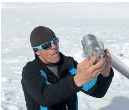
Schichtleiter Kilian Schniedrig kann den Düsenkopf der Lanze um 60 Grad drehen.
