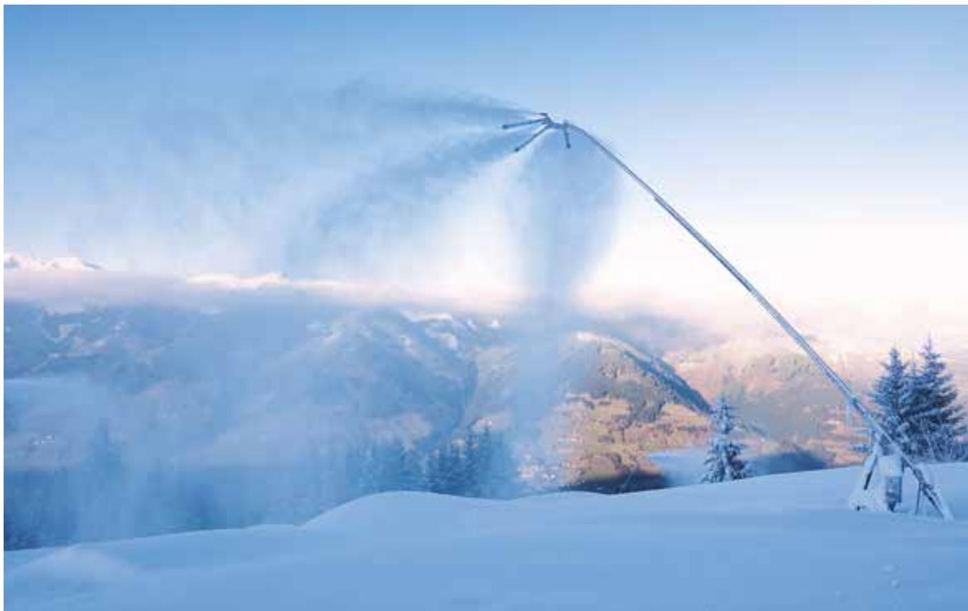
Die BÄCHLER SnoTek TRIDUSA produziert bis 21 m<sup>3</sup> Schnee pro Stunde im Grenztemperaturbereich und ermöglicht so eine wirtschaftliche Schneeproduktion. Fotos: BÄCHLER
