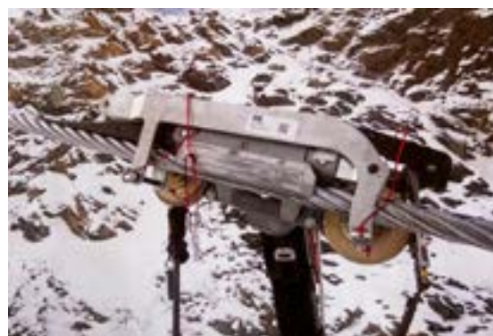
Öffnungsvorrichtung mit welcher eine Klemme geöffnet und bis zur nächsten Stütze geschoben werden kann.
